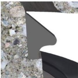
Giunto elastomerico in SBR del tipo a “strisciamento” e sezione cuneiforme in conformità alla norma UNI EN 681-1.
