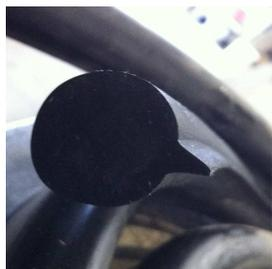
Guarnizione elastomerica in SBR del tipo a "schiacciamento" con sezione a goccia e durezza di 40 +/- 5% IRHD, in conformità alla norma UNI EN 681-1.
