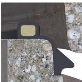
Giunto elastomerico in SBR del tipo a “strisciamento” a sezione cuneiforme, prelubrificato per facilitare la posa, munito di ripartitore di carico, conforme alla norma UNI EN 681-1.
