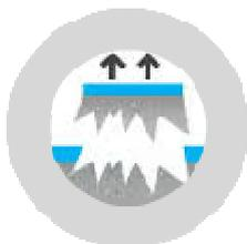
**Resistenza allo strappo per trazione diretta** elevatissima con risultati di prova effettuati secondo la norma EN 1542 di **4,50 N/mmq**, rispetto ai valori previsti dalla norma superiori o uguali a 1,0 N/mmq.
