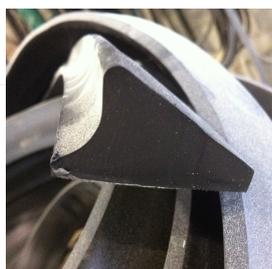
Guarnizione elastomerica in SBR del tipo a "strisciamento" a sezione cuneiforme con durezza di 40 +/- 5% IRHD, in conformità alla norma UNI EN 681-1.
