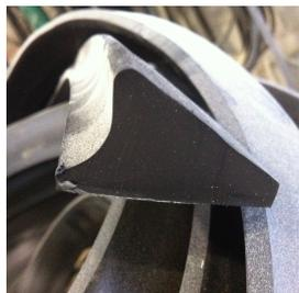
Guarnizione elastomerica in SBR del tipo a "strisciamento" di sezione cuneiforme con durezza di 40 +/- 5% IRHD, in conformità alla norma UNI EN 681-1.
