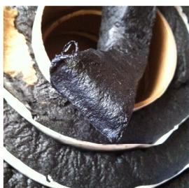
Giunto butilico "Butylrubber" di sezione quadrata 22x22 mm., in grado di assicurare la tenuta idraulica tra superfici piane.
