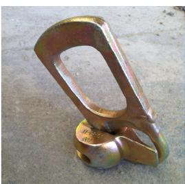
Maniglione da 2,5 Ton. necessario alla corretta movimentazione delle basi e di tutti gli elementi che compongono il pozzetto.
