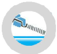
**Resistenza all'abrasione** con metodo di prova Taber secondo la norma EN 5470/1 con risultati di perdita di peso di **192 mg**, nettamente inferiori ai 3000 mg indicati come limite max. dalla norma stessa.
